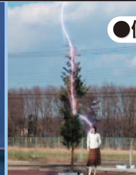
音羽電機工業株式会社“雷”写真コンテスト提供 マネキン人形を使った側撃雷の実験 (電力中央研究所提供)
